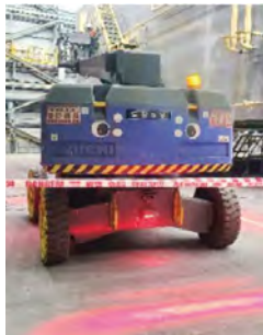
경광등, 바리케이트 후 고소차 작업(개선사례)
